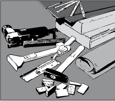
**1** Alles bereit? PE-Folie und Kleband. Als Werkzeug: Zollstock, Bleistift, Stichsäge, Fuchsschwanz, Fäustel, Setzlatze, Zugeisen, Schlagholz und Abstandskeile. Für Vinylan Hydro zusätzlich Trittschalldämmung.
