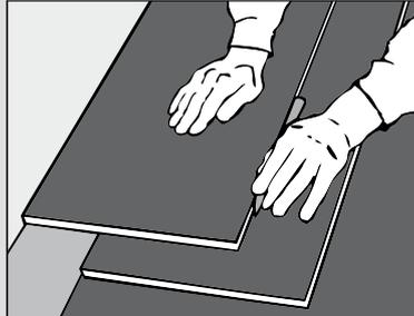
**6** Einpassen der letzten Dielenreihe: Legen Sie exakt auf die zuletzt verlegte Dielenreihe die nachzusägende Diele. Dann zeichnen Sie mit Hilfe einer weiteren Diele den Längsschnitt an.
