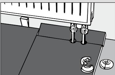
**4** Bei Heizungsrohrdurchbrüchen die Diele am Stoß ausklinken und mit Heizkörperrossetten abdecken.
